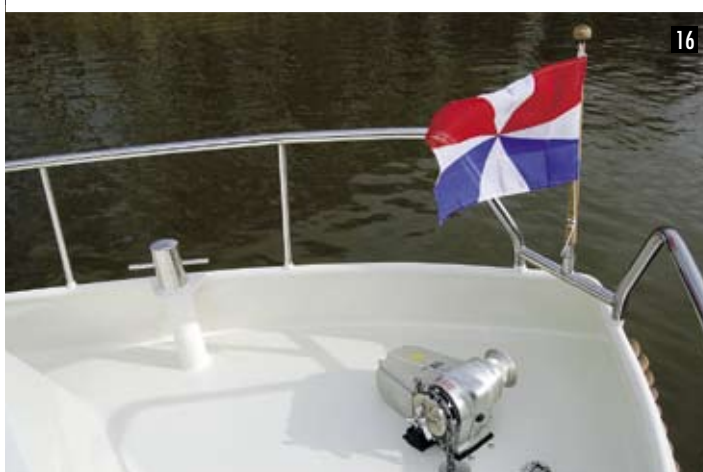
14 Eigenaarshut. 15 Ingang hondenkooi. 16 Voordek, met ankerlier en boven het boeisel uitstekende bolder. 17 Machinekamer onder de kuipvloer.
